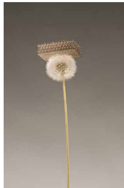
1 pav. Itin lengva metalinė mikrogardelė Fig. 1. Ultra light metallic micro gridron
