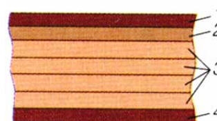
4 pav. Daugiasluoksnis kartonas: 1 – išorinis sluoksnis, 2 – posluoksnis, 3 – vidiniai sluoksniai, 4 – apatinis sluoksnis
