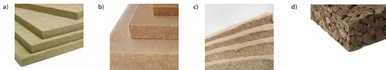
3 paveikslas. Analizuojamos medžiagos: a) akmens vata, b) medžio plaušo plokštės, c) kanapių pluošto vata, d) ekspanduoto kamščio plokštės
