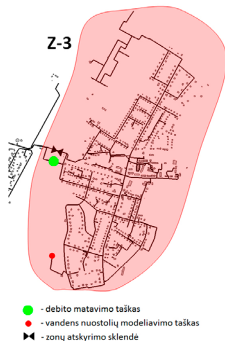
5 pav. Z-3 matuojamosios zonos schema su pažymėtais debito matavimo ir vandens nuostolių modeliavimo taškais
