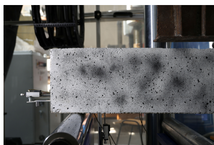
6 paveikslas. S1 tipo sija po bandymo (šaltinis: autoriaus nuotrauka)
