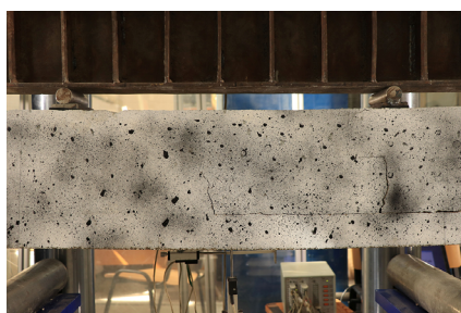
6 paveikslas. S1 tipo sija po bandymo (šaltinis: autoriaus nuotrauka)
