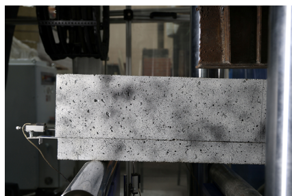
7 paveikslas. S2 tipo sija po bandymo (šaltinis: autoriaus nuotrauka)
