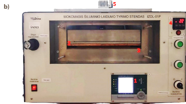
1 paveikslas. Eksperimento įranga ir medžiagos: a) tiriamosios medžiagos plokštelė; b) IZOL-01P šiluminio laidumo tyrimo stendas
