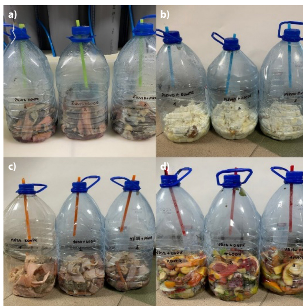
2 paveikslas. Paruoštas eksperimentinis tyrimas kvapo koncentracijai nustatyti (kontrolinis mėginys, su valgomąja soda ir su probiotikais) esant skirtingoms maisto atliekų rūšims: a) žuvis; b) pieno produktai; c) mėsa; d) vaisiai ir daržovės
