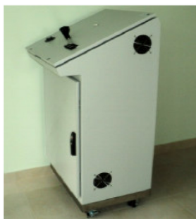
3 paveikslas. Olfaktometras AC'SCENT® International (Kvapų tyrimų laboratorija, n. d.)
