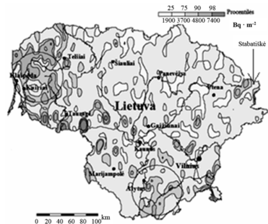
2 pav. ^{137}\text{Cs} paviršinio aktyvumo tankio ( \text{Bq} \cdot \text{m}^{-2} ) pasiskirstymas, nustatytas spektrometru iš lėktuvo 1987 m. (Butkus 2006)
