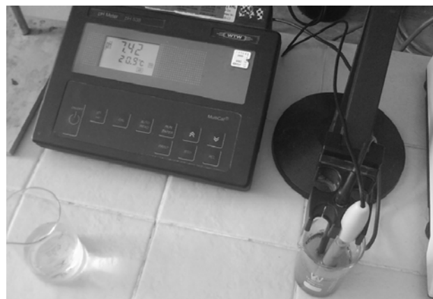
7 pav. Rūgštingumo nustatymo prietaisas (MTW pH 538)
