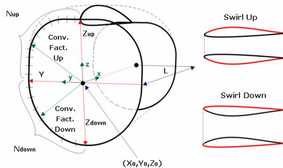
Fig. 5. Nacelle parameters
